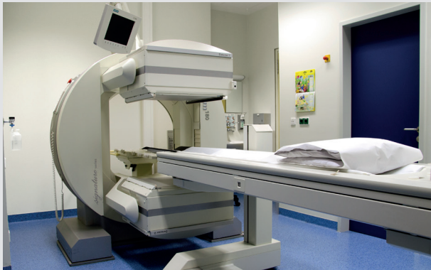
Digitale Doppelkopf-Gammakamera mit SPECT-Schichtbildtechnik
